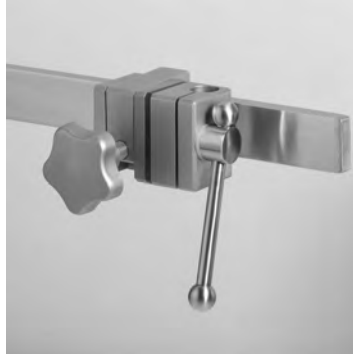
19799-02 Klemmsockel aus rostfreiem Stahl, für ein höhenverstellbares Stativ Ø 16 mm, elektrisch isoliert bis 1,5 kV AC, Spannweite 35 mm für Schienen 25/32 x 8/12 mm. Clamp socket made of stainless steel, for height-adjustable stand Ø 16 mm, electrically insulated up to 1.5 kV AC, holding width of 35 mm for rails 25/32 x 8/12 mm.
