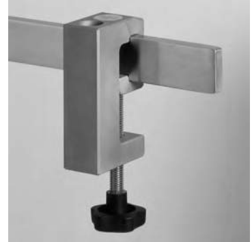
19799-03 Leichtmetall-Klemmsockel Spannweite 35 mm, für ein Schraubstativ mit Ø 16 mm/M10, für Schienen 25/35 x 8/10 und Rohre Ø 12 - 35 mm. Clamp socket made of light metal, holding width 35 mm, for screw stand Ø 16 mm/M10, for rails 25/35 x 8/10 and tubes Ø 12 - 35 mm.
